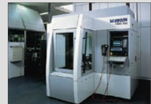
Hochgeschwindigkeitsfräsmaschine mit 14 kW Leistung, 42 000 U/min
