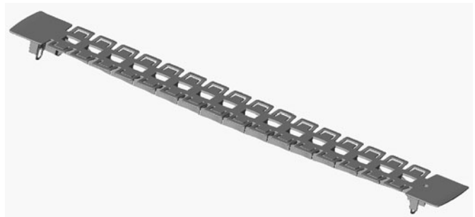
Abb. 1: Mittels SolidWorks erstelltes CAD-Modell eines MANKAU-schen Lattenrost-Federelementes
