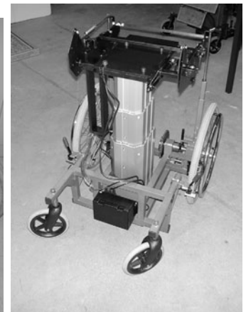
Bild 4: Grundrahmen mit ausgefahrener Sitzhöhenverstellung, Gesamthubweg: 400 mm
